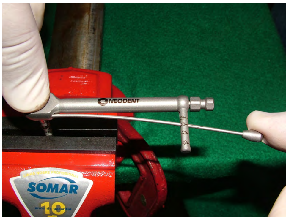
Figura 10. Aplicação do torque recomendado pelo fabricante ao parafuso do pilar protético
