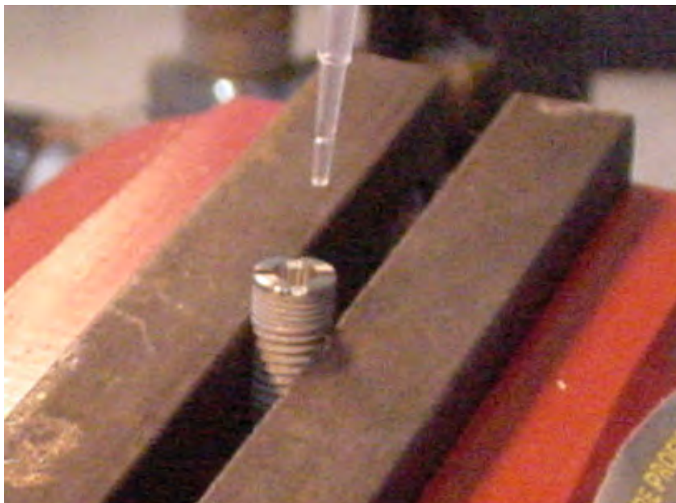
Figura 9. Solução contendo Escherichia coli sendo inoculada em implante do sistema Neodent Cone Morse
