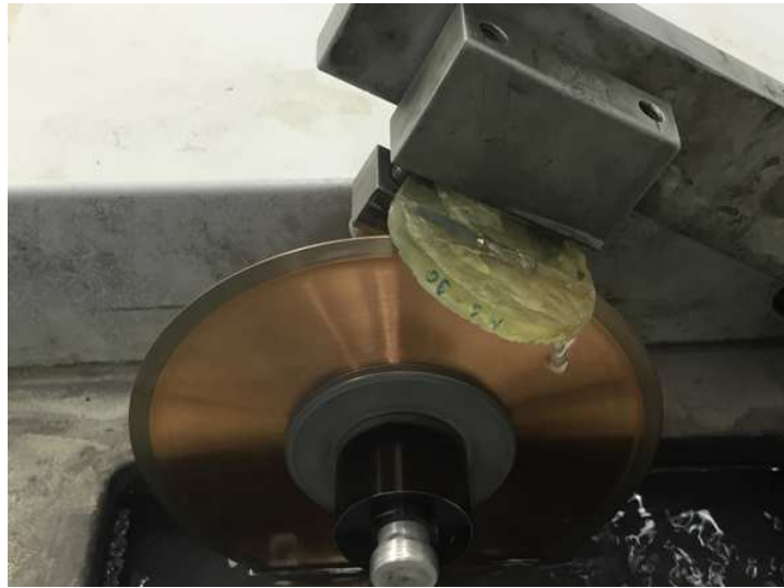
Figura 10 – Corte da amostra em cortadeira metalográfica de precisão com disco de diamante.
